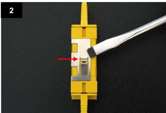
Auf der Unterseite, mit einem Schraubenzieher, den kleineren Winkel flach herunterdrücken. Sonst sitzt das Mittelstück später nicht richtig im Gehäuse.
