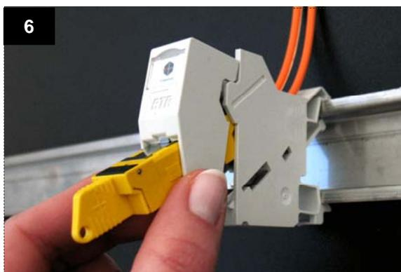
Den Gehäusedeckel oben im Gehäuseunterteil einhaken und nach unten einrasten.
