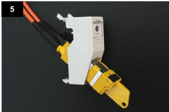
Das Patchkabel ins Mittelstück einsetzen.
